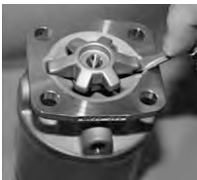
Abbildungsnummer 8: Entfernen Sie die Druckbaugruppe
