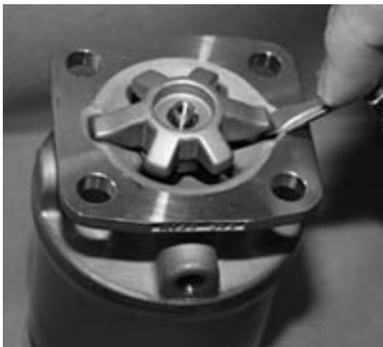
Рис. № 6: Демонтаж компрессора
