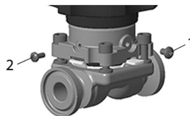
**Figura 11: BioviZion/PFuZion 0,5 pulgadas con tornillo de casquete sellado y retención con anillo de presión**
