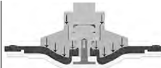
Abbildungsnummer 2: Druckbaugruppe bei Advantage-Aktuator 2.0
