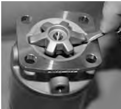
Abbildungsnummer 7: Entfernen Sie die Druckbaugruppe
