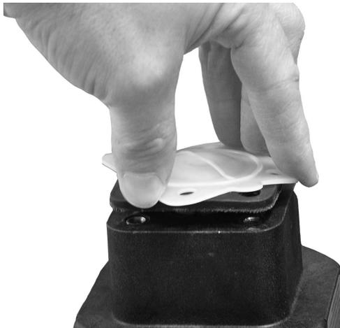
5. Die Membran zurückdrehen (maximal eine halbe Umdrehung) bis die Schraubenlöcher von Membran und Ventildeckelflansch übereinander liegen.
