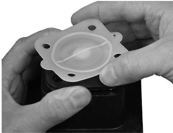
3. Die Membran bis zum Anschlag oder zu einem starken Widerstand drehen, so dass sie durch weiteren Kraftaufwand nicht mehr wesentlich weiter in die Druckbaugruppe eingeschraubt wird.
